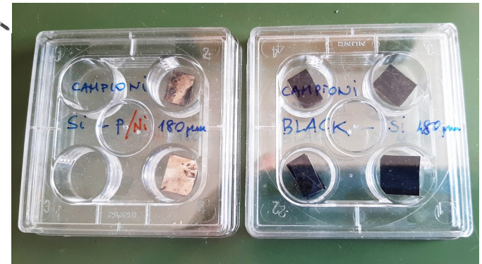
Si-rGO Betavoltaic cell prototypes (Dip. di Fisica e Geologia, UNIPG and INFN Perugia)
